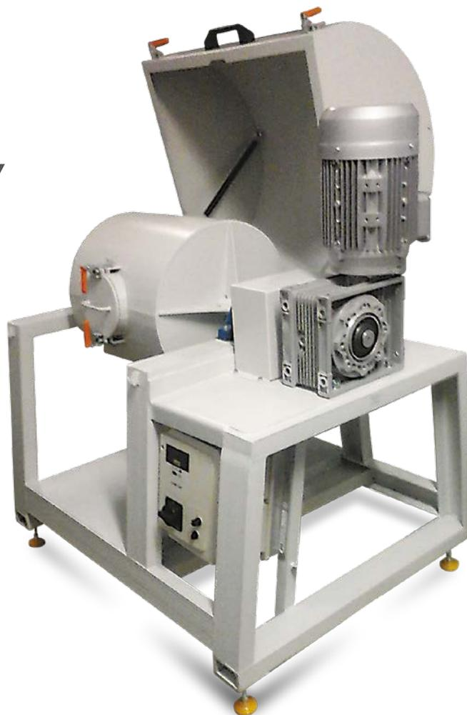
Шаровые мельницы VILITEK VBM позволяют измельчать широкий спектр образцов руд и различных нерудных материалов: стекло, керамику, минералы, руды черных и цветных металлов, сплавы, химикаты, растительное сырье, грунты, осадки сточных вод и т.д. Мельницы VBM отлично подходят для подготовки проб, наработки партий материалов в опытных производствах, исследования измельчаемости материалов в различных режимах, исследований по методике Бонда.
