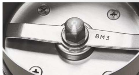
Лезвия мельниц серии D изготовлены из нержавеющей стали с высокой твердостью HRC 55 по Роквеллу, таким образом мельницы могут измельчать практически любые сухие материалы, твердость которых ниже. В случае если необходимо измельчение волокнистых материалов рекомендуется предварительное тестирование измельчаемости этих материалов в нашей лаборатории.
